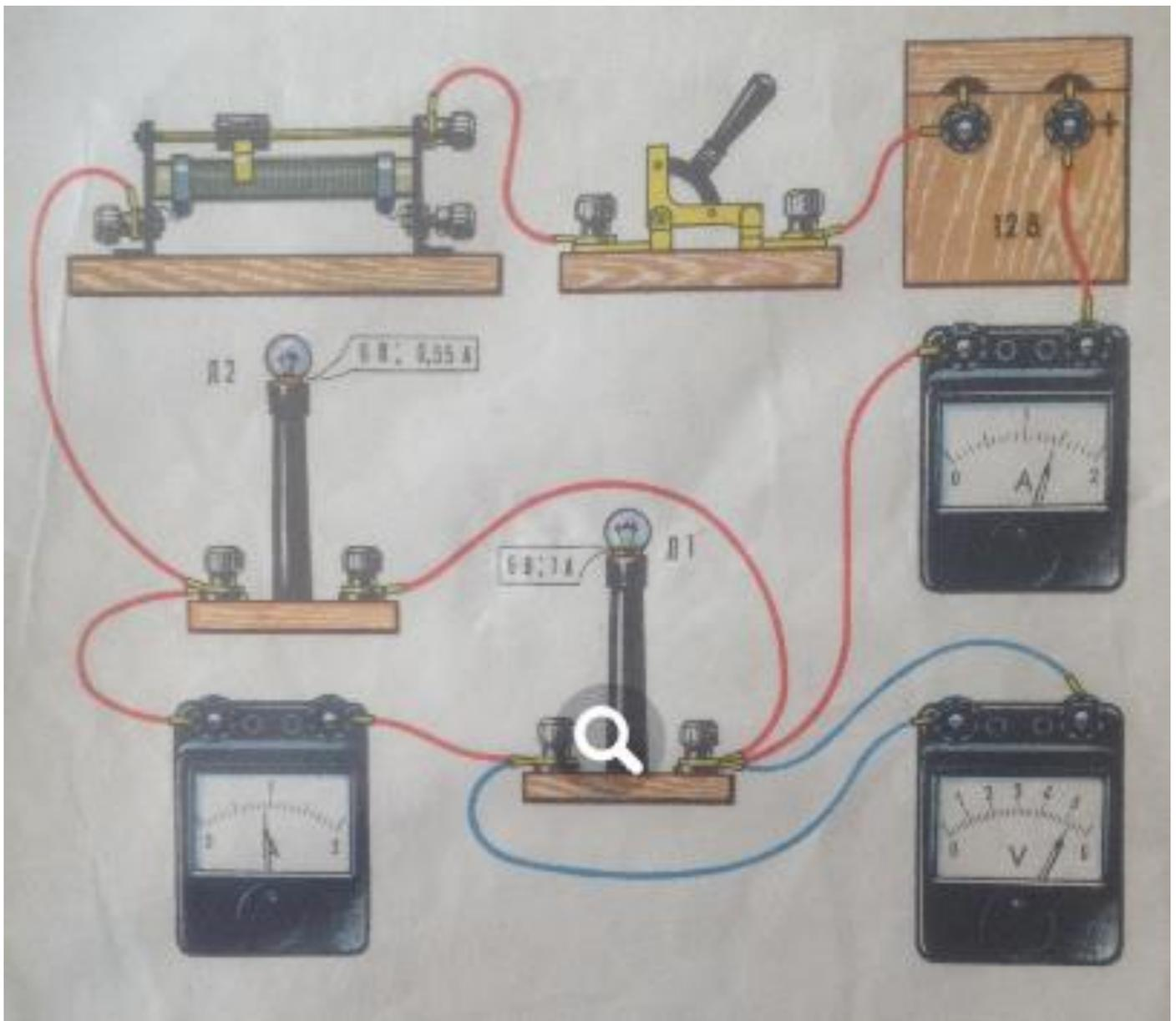
1. Нарисуйте принципиальную схему изображенной электрической цепи и отметьте на ней знаками (+, -) полярность зажимов электроизмерительных приборов, а стрелками — направление тока в цепи.
